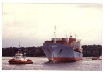
Schiff fest oder legen sich zum Drücken längsseits. So können sie den verschiedenen Anforderungen als Brems-, Steuer- und Bugsierhilfe am ehesten gerecht werden. Durch den erheblich größeren Hebelarm – bezogen auf den Drehpunkt des Schiffes – sind sie effektiver als das bordeigene Querstrahlruder.
